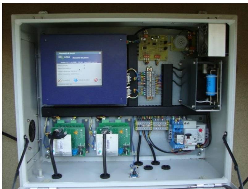
Foto 6: detalle del equipo de detección de marcas PIT de CIPAM
