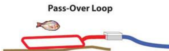
Esquema 2: Esquema de una antena Pass-Over (Fuente: Oregon RFID)
