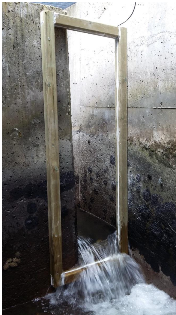
Foto 9: Antena pass-through instalada en la escala de peces de Murgues
