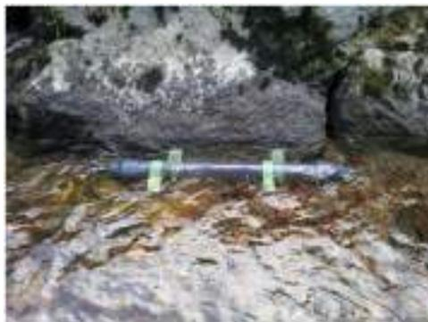
Figura 7: Imagen del muestreador pasivo instalado en la estación de aforos de Leitzaran que recoge los sedimentos en suspensión integrados en el tiempo.
