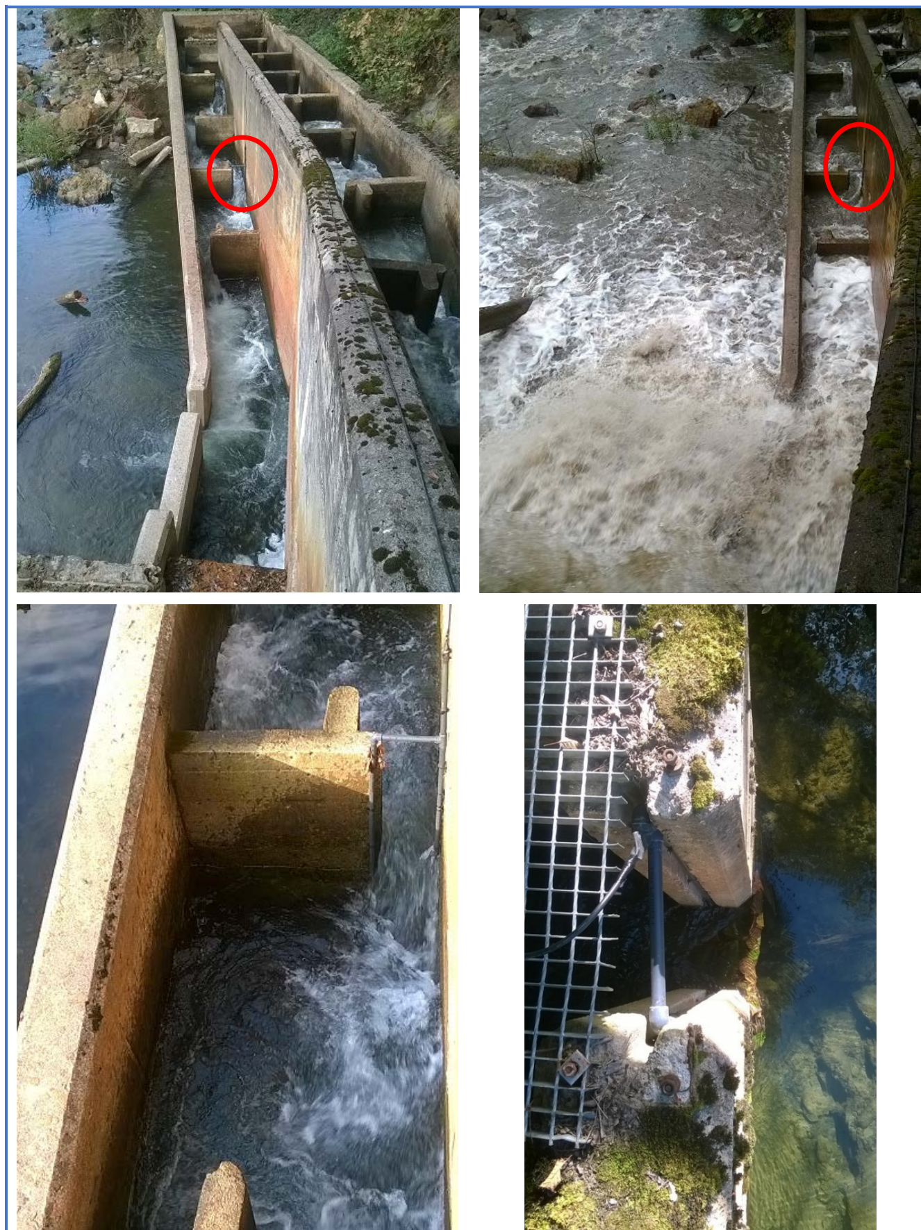
Figura 3. Localización de la antena 1 en la escotadura entre la 2ª y 3ª artesa con caudales bajos y altos (círculos rojos), imagen de detalle (abajo izquierda) y antena 2 en la artesa superior de salida (abajo derecha).
