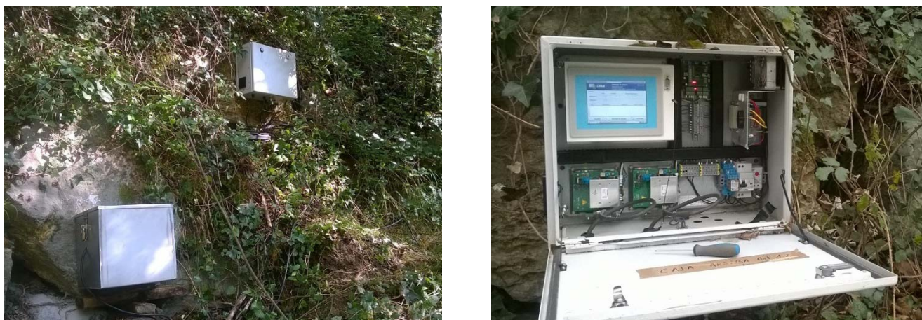
Figura 8. CPU del sistema de detección (CIPAM) instalado junto a la escala y alimentación a 12 V.
